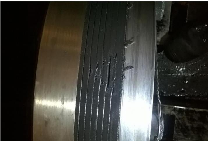
Kolbendichtungen durch verschmutztes Öl stark beschädigt.
