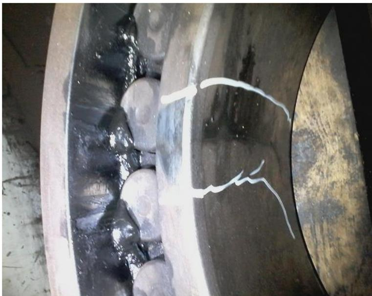
Lagerschäden, hervorgerufen durch Schmierstoffmangel. Kontrollieren sie immer ob die gewünschte Menge des Schmiermittels an der richtigen Stelle ankommt.
