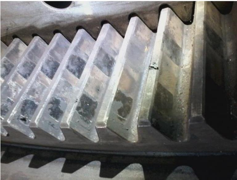
Eingelaufene Zähne im Getriebe.
